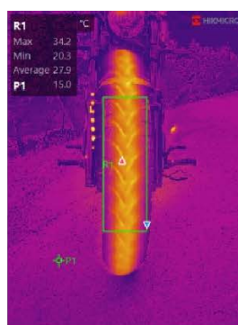
Pneu Dianteiro. Calor e Padrão de Desgaste dos Pneus
