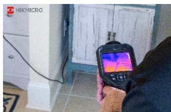
Inspeção de Piso Radiante
